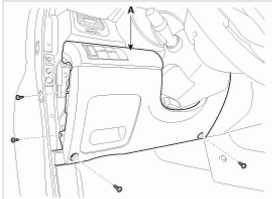
3. 分离SMARTRA模块的5P连接器，拧下螺栓后拆卸SMARTRA模块(A)。
